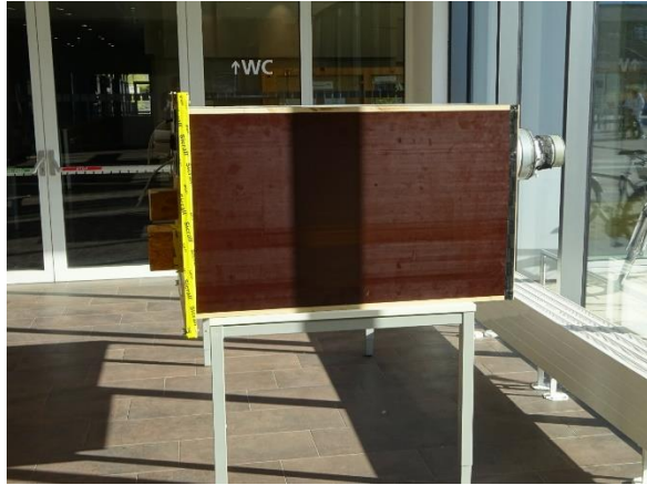
Seitlicher Anschluss für den Druckmessschlauch sowie rückseitiger Anschluss für den Druckschlauch
