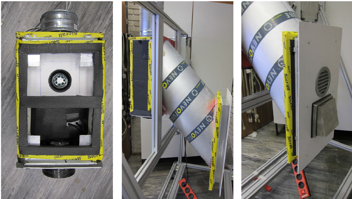
Figure 43 (Quelle: UIBK) Links: Geöffneter Ventilatorkasten mit Außen- und Abluftventilator, Mitte: Seitenansicht mit Ventilatorkasten, Wärmeübertrager im 45° geneigten Zylinder, der in der Kernlochbohrung installiert wird, Rechts: Außenluftansauggitter und Fortluftauslass an der Außenoberfläche der Außenwand
