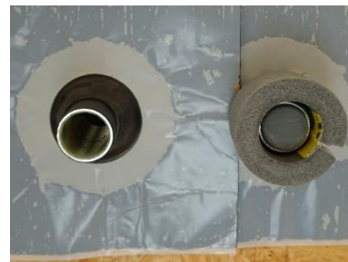
Seitlicher Anschluss für den Druckmessschlauch sowie rückseitiger Anschluss für den Druckschlauch
