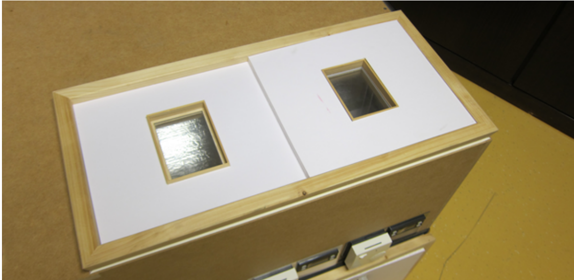
Figure 33 (Quelle: UIBK) : Links oben: Thermographie; Rechts oben: Innenansicht; Unten: Gedämmtes und ungedämmtes Fenster im Modellaufbau (In der unteren Bildhälfte sind die Thermostaten zu erkennen)
