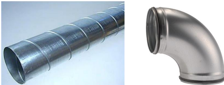
Figure 51 (Quelle: UIBK) Lüftungskanäle Wickelfalz (links); 90°-Bogen, verzinkter Stahl mit Lippendichtung (rechts)
