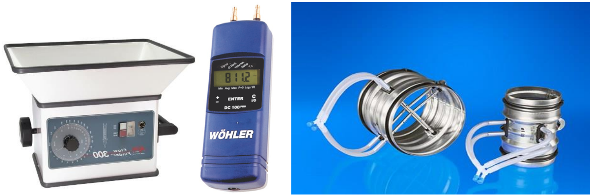
Figure 52 (Quelle: UIBK) FLOWFINDER [Quelle: ACIN INSTRUMENTS BV], Wöhler Druchdifferenzmessgerät, Volumenstrom Messkreuze [Quelle: Halton]
