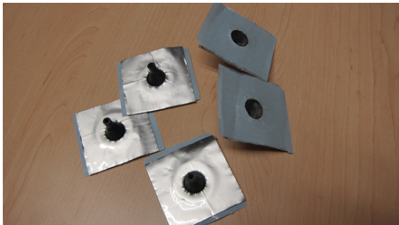
Figure 5 (Quelle: UIBK) Muster für Luftdichtheitszubehör: Kabeldurchführungen (links), Folienmaterialproben (rechts)
