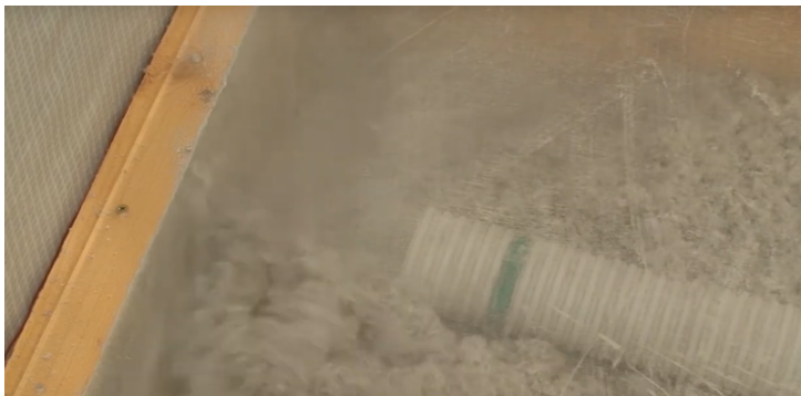
Figure 9 Mit Hilfe eines Kastens der mit einer Plexiglasplatte abgedeckt ist, kann der Einblasvorgang beobachtet und kontrolliert werden
