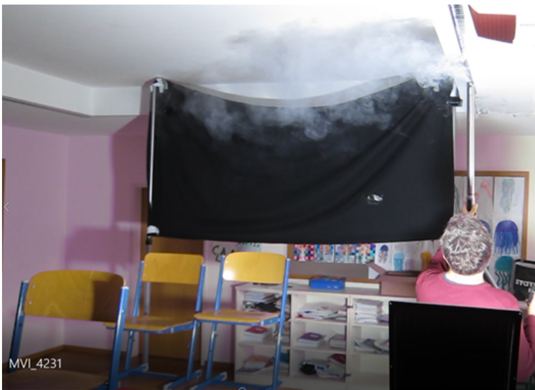
Figure 11 (Quelle: UIBK) Strömungsvisualisierung des Zuluftinlasses in einem Klassenraum mit Nebel
