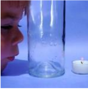
Figure 10 (Quelle: experimentis: Physik für Alle ) Ausblasen einer Kerzenflamme durch Anblasen einer Glasflasche
