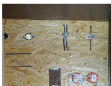
Rückseitenansicht (Innenansicht) der Kabelmontagen und Steckdosen sowie Rohrdurchführungen
